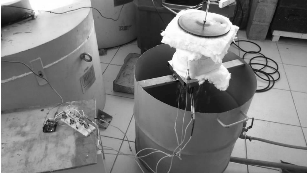
Figura 7. Sistema de aquisição de dados, lingoteira e sistema de refrigeração.
