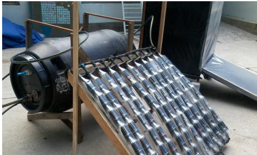
Figura 6: Aquecedor solar de garrafas PET.
