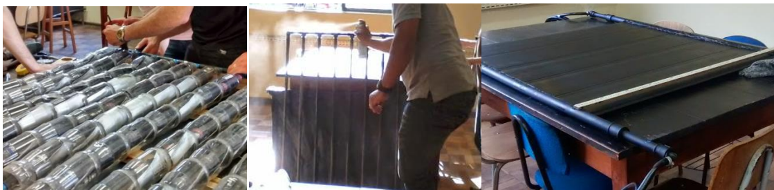
Figura 1: Tipos de painéis que compõem o aquecedor solar.
