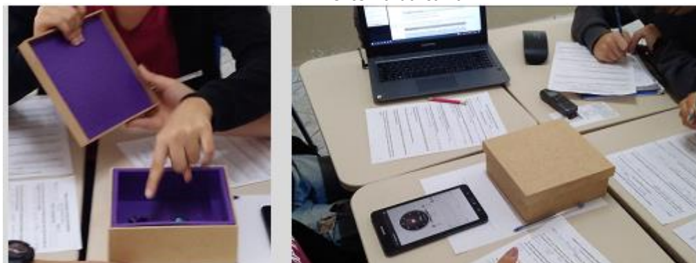
Figura 5: Experimento para verificar a atenuação do som. À esquerda, uma das caixas utilizadas, com revestimento de EVA. À direita, um grupo de alunos efetuando medidas do nível sonoro na área externa da caixa.
