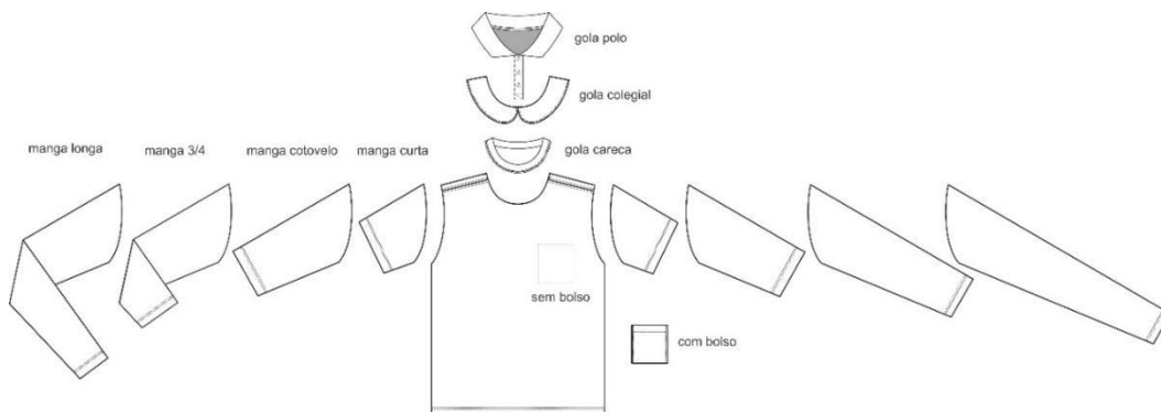
Figura 2 — Desenho Técnico de uma camiseta e seus componentes para a customização em massa.
